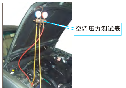
图8-16 空调压力测试
