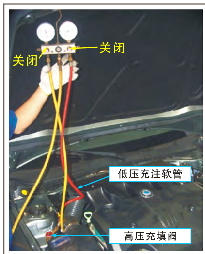
图8-21 空调压力检查
