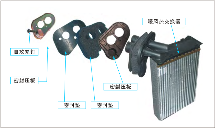
图8-11 暖风热交换器的分解图
