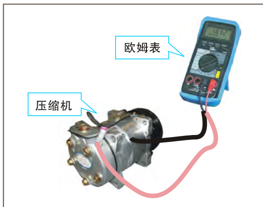
图8-22 测量定子线圈电阻
